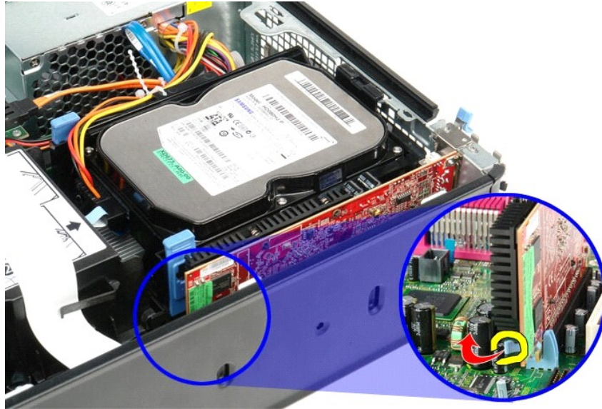
5. אחוז בכרטיס מהפינות שלו והוצא אותו מהמחבר בלוח המערכת.
