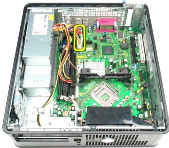
01. הסר את כבל לוח הקלט/פלט מלוח המערכת.
