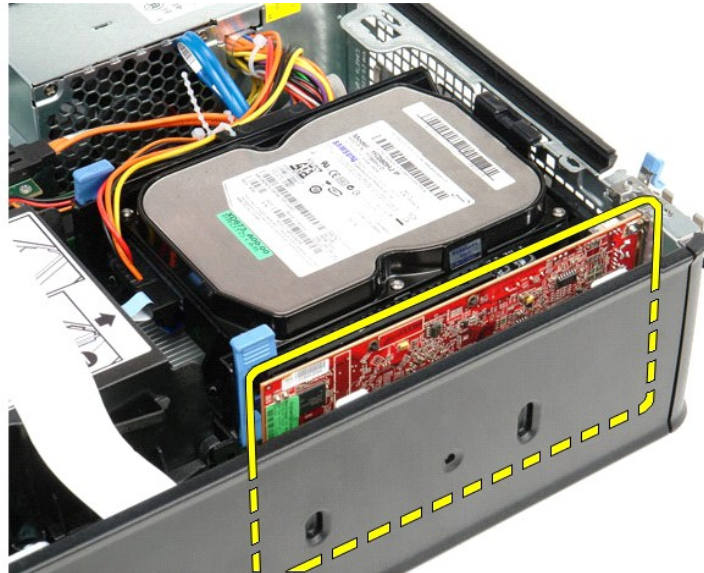
5. אחוז בכרטיס מהפינות שלו והוצא אותו מהמחבר בלוח המערכת.
