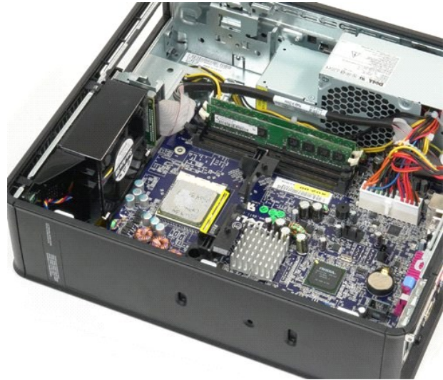
5. הרם את המעבד והוצא אותו מהשקע שלו בלוח המערכת.
