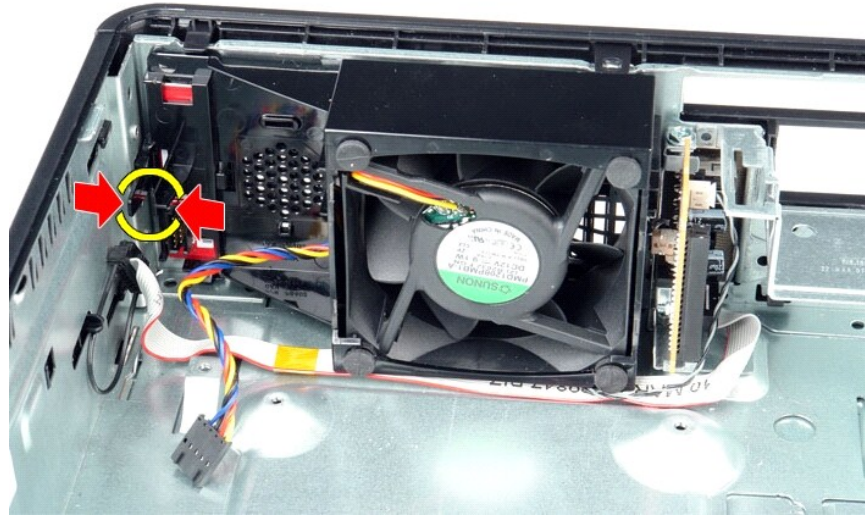
5. הטה את המאוורר קדימה והסר אותו ממארז המחשב.
