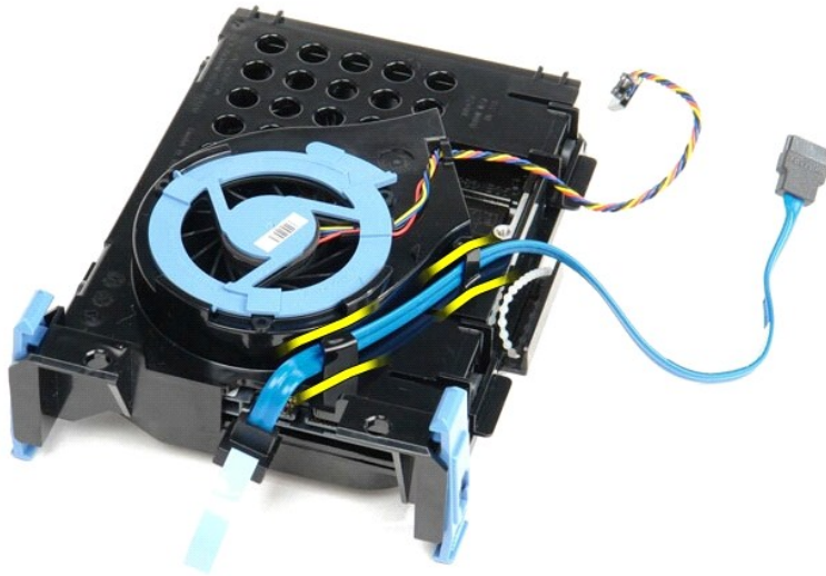
01. הסר את כבל המאוורר של הונון הקשיח מצידו החיצוני של מכלול הונון הקשיח.
