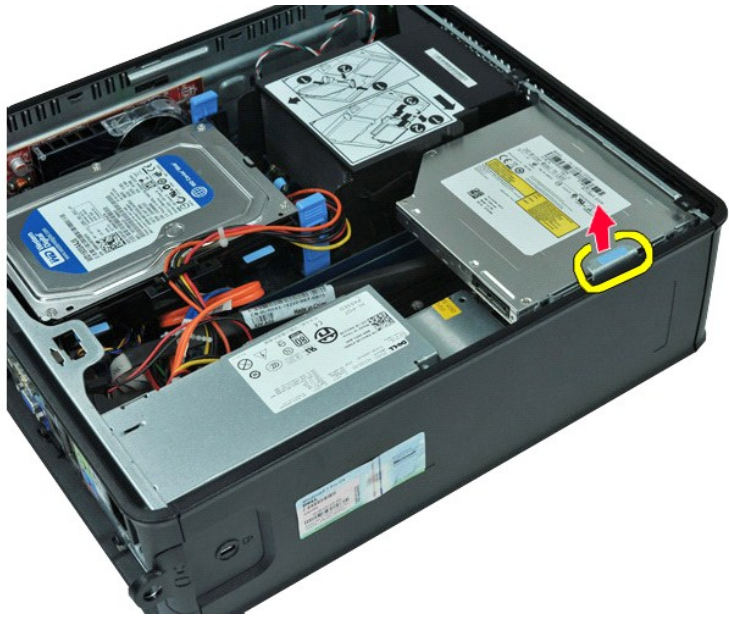
4. משוך את תפס שחרור הכונן כלפי למעלה והחליק את הכונן האופטי אל עבר גב המחשב.
